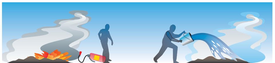
Vorsicht vor Wiederentzündung - Glutnester immer mit Wasser nachlöschen
